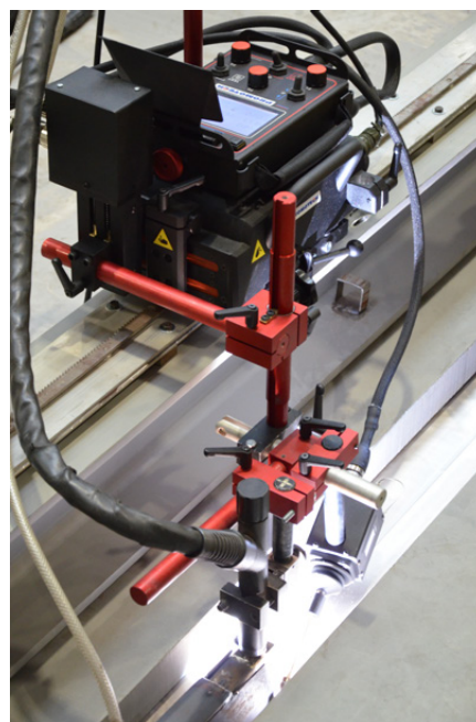
Sømsporing fungerer med og uten oscillasjon
