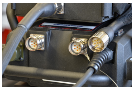
Ny type signalluttak og plugger
