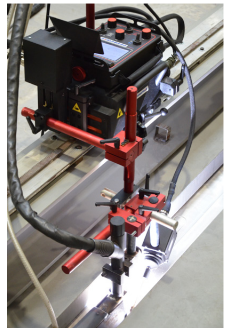
Il sistema segui giunto funziona anche con oscillazione attiva
