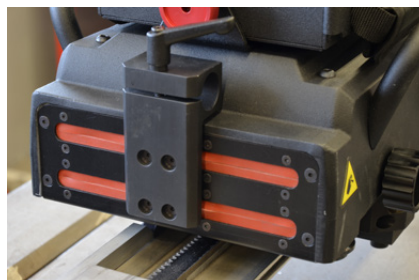
Le coperture in silicone proteggono dallo sporco e dalle proiezioni di saldatura
