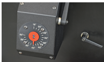
正確な開先角度調整機構
