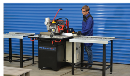
長尺ワーク用補助テーブル
