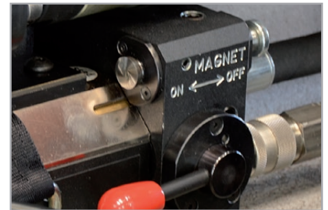
Bescherming tegen starten van de motor wanneer de magnetische basis niet is geactiveerd
