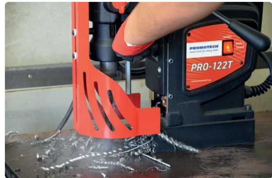
Spiraalboor max 31.75 mm (1-1/4") Maximale slag 225 mm (9")
