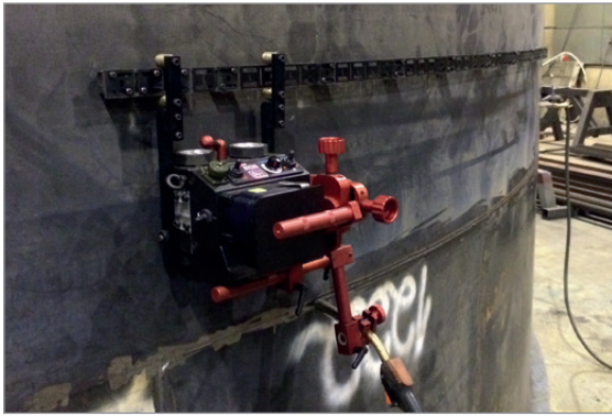
Flexible Spurlänge 185 cm (6ft) 1 St. Minimaler Krümmungsradius von 1,0 m PRW-0466-50-01-00
