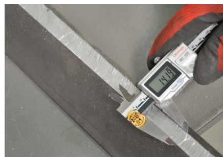
Максимална ширина на скосяване до 14 мм
