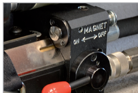
Protezione contro l'avviamento del motore quando la base magnetica non è attiva
