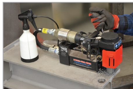
Sistema di raffreddamento attraverso il mandrino
