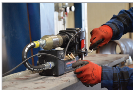
Leva d'avanzamento fissabile su entrambi i lati
