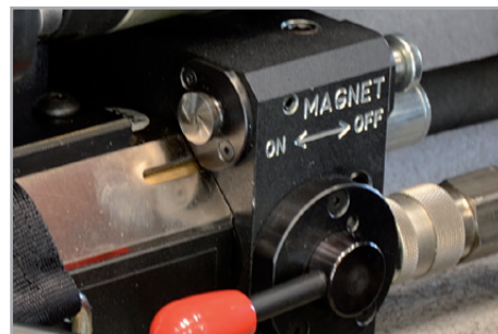
Schutz gegen Anlaufen des Motors, wenn die Magnetbasis nicht aktiviert ist
