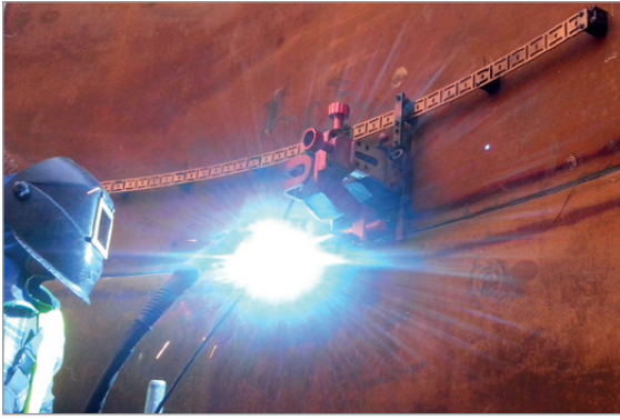
Flexibilní vodící lišta - délka 185cm (6ft) 1ks Minimální poloměr zakřivení 1,0 m (3,3 ft) PRW-0466-50-01-01-0
