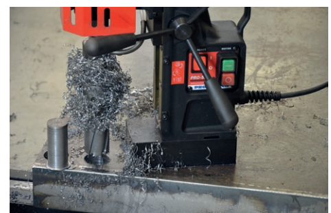
Maximale Fräskapazität bis zu 45 mm Maximale Schnitttiefe bis zu 75 mm - (Optional)
