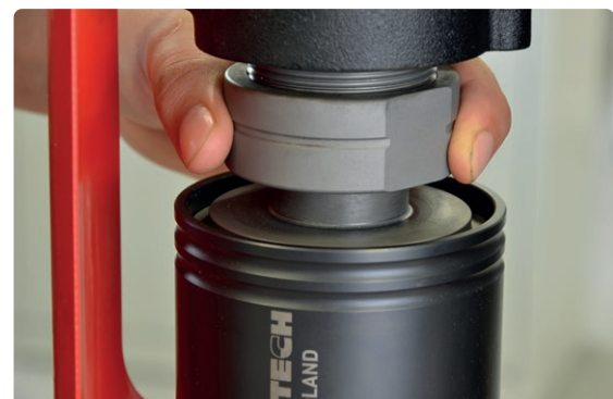
Gewindeschneidfutter mit Sicherungsmutter
