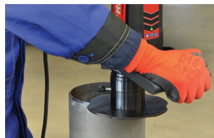
Afschuinen van buizen
