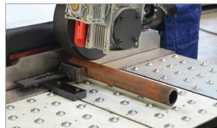
Mögliche Rohranfasen am AD
