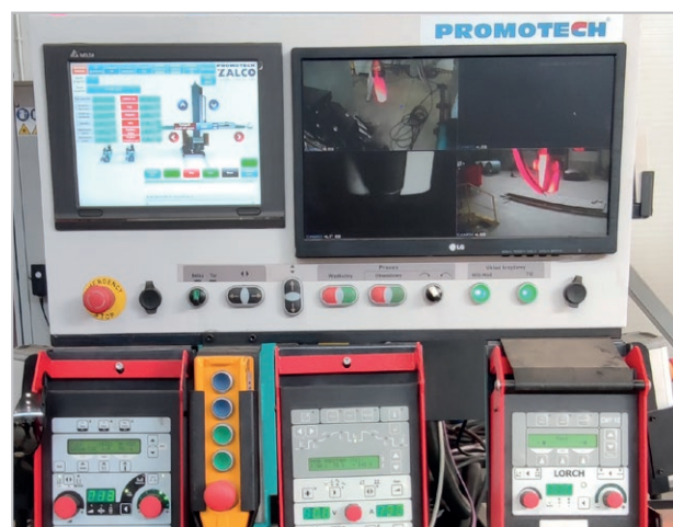
Vista del pannello operativo del sistema C&B con relativo generatore per saldatura MIG/MAG (EASB e LORCH)
