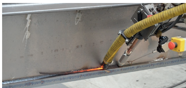
Il sistema segui giunto automatico Promotech garantisce una saldatura corretta e ripetibile grazie al semplice processo di rimozione degli sfridi.
