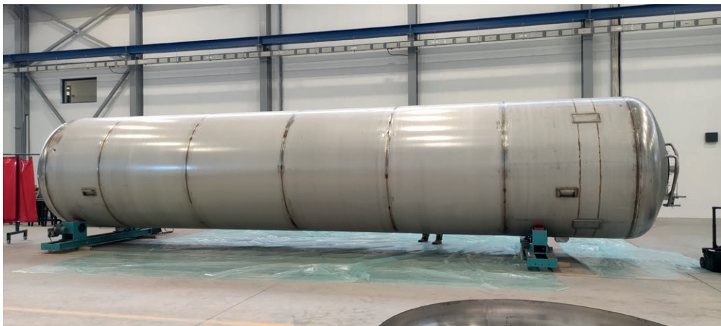
CONTROLLO QUALITA' NESSUN DIFETTO DI SALDATURA
