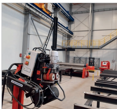
Smussatrice ABM-50 per ottenere cianfrini superiori ed inferiori di alta qualità
