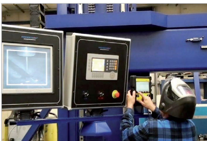
Vista del pannello operativo del sistema C&B con relativo generatore per saldatura MIG/MAG (EASB e LORCH)
