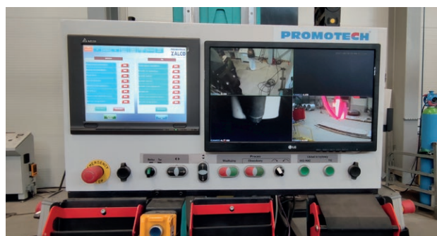
Il sistema segui giunto automatico Promotech garantisce una saldatura corretta e ripetibile grazie al semplice processo di rimozione degli sfridi.
