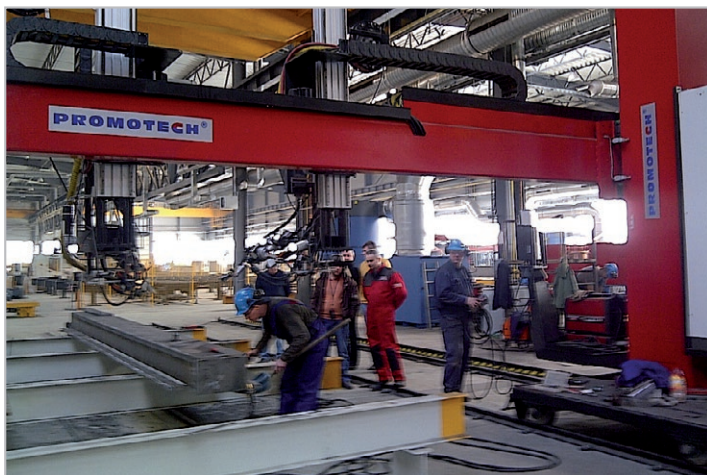
Vista del pannello operativo del sistema C&B con relativo generatore per saldatura SAW AC/DC (Lincoln Electric ed ESAB)
