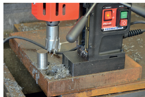
Kernboor max 40 mm Max frees diepte 50 mm
