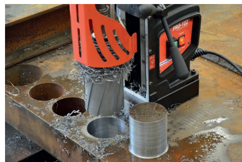
Fräslleistung bis zu 100 mm Maximale Tiefe bis zu 100 mm Max. Hub bis zu 225 mm
