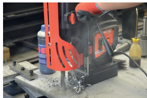
Bohrleistung bis zu 31.75 mm Geringes Gewicht von nur 24 kg
