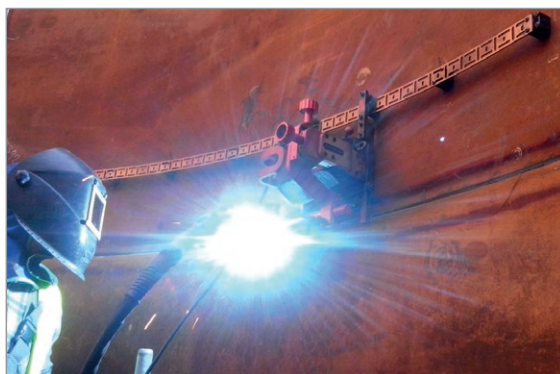
36 mm breite flexible Führung 1.85 m. Minimaler Krümmungsradius von 1,0 m PRW-0466-50-01-01-0
