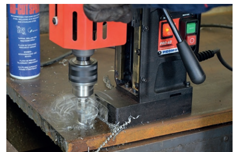
Bohrleistung bis zu 16 mm
