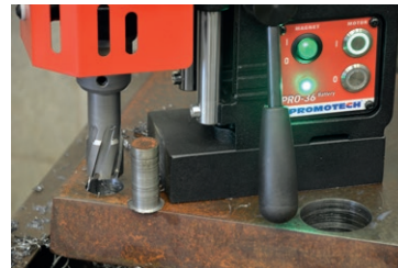
Maximale Fräskapazität bis zu 36 mm Maximale Schnitttiefe bis zu 50 mm
