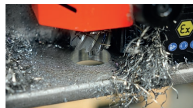
Maximale Fräskapazität 40 mm
