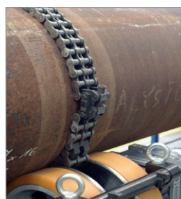
La catena regolabile ( \varnothing 200 - 1000\text{mm} ) assicura una rotazione assiale positiva
