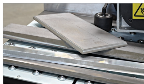
Risultati di smussatura di alta qualità
