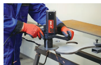
Smussatura radiale di bordi ad arco
