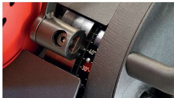
Impostazione precisa dell'angolo di smussatura
