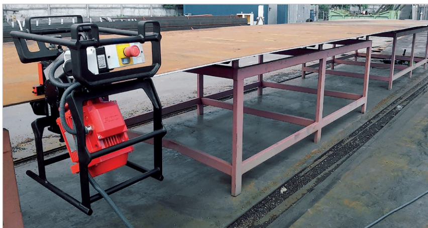
La smussatrice ABM-14 avanza automaticamente lungo la lamiera
