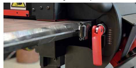
Gemakkelijke aanpassing aan plaatdikte
