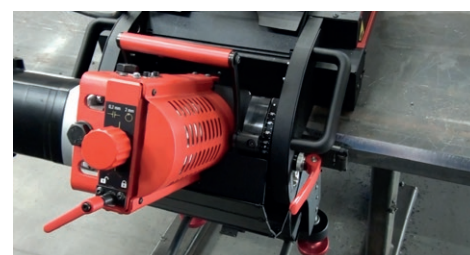
Innovatief en ergonomisch instelbaar. De ontgrendelingshendel is handbediend en vereist geen extra gereedschap
