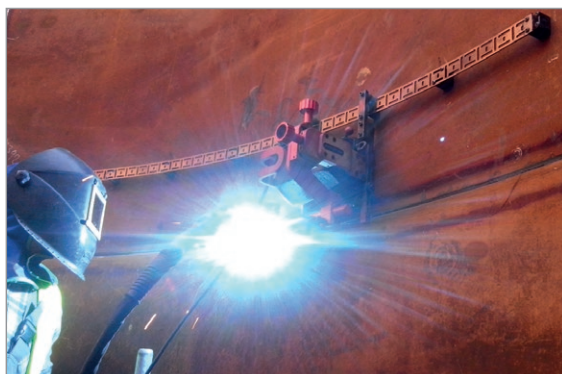
Rail flexible de longitud 185cm 1pc Radio mínimo de curvatura de 1.0 m PRW-0466-50-01-01-0
