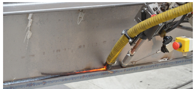
Urmărirea automată a îmbinărilor mecanico-electrice Promotech asigură o sudare corectă și repetabilă prin intermediul unui proces ușor de îndepărtare a stropilor.
