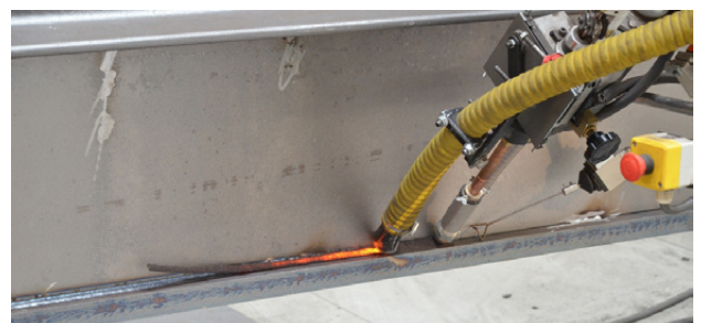
Promotech automatisch mechanisch-elektrisch lasnaadvolgsysteem zorgt voor correct en repeteerbaar lassen door middel van een eenvoudig slakverwijderingsproces.
