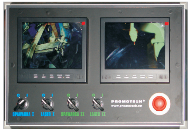
Optionele uitrusting omvat: camerasysteem voor GMAW (MAG)/SAW.
