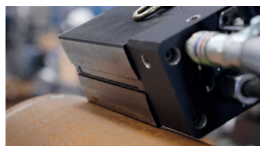
Base magnética prismática en forma de V para la perforación de tubos
