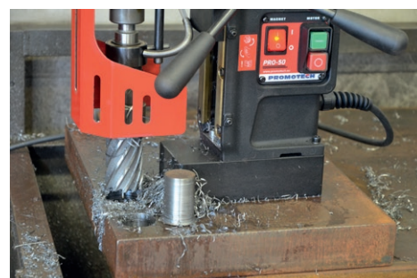
Capacidad de fresado de hasta 50 mm Profundidad de corte de hasta 75 mm - opción
