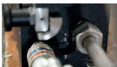
Indicador de nivel de sujeción para mayor seguridad
