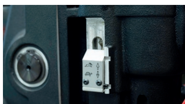
Caja de 2 velocidades para adaptar la velocidad a la herramienta
