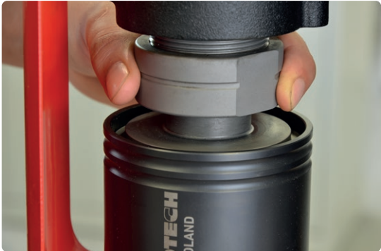
El mandril de roscado equipado con tuerca de seguridad protege la herramienta de roscado contra la extracción
