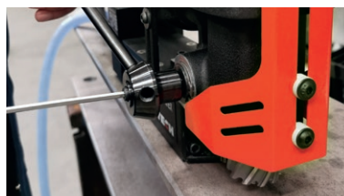
La empuñadura de avance se puede fijar por ambos lados
