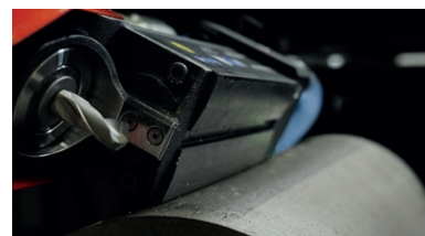
Base magnética prismática en forma de V para la perforación de tubos
