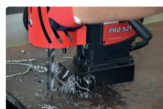
Capacidad de taladrado de hasta 23 mm Máx. recorrido hasta 190 mm
