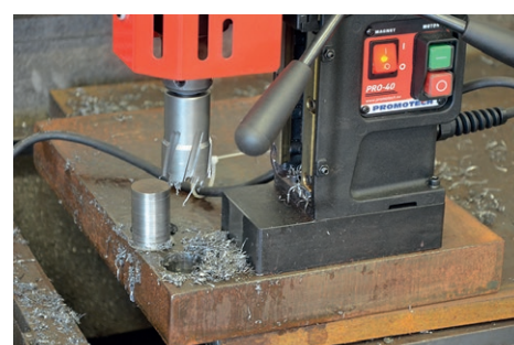
Capacidad de fresado de hasta 40 mm Profundidad de corte de hasta 50 mm
