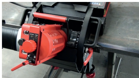
L'innovativo ed ergonomico sistema di regolazione dell'angolo di smusso con leva di rilascio non richiede strumenti aggiuntivi
