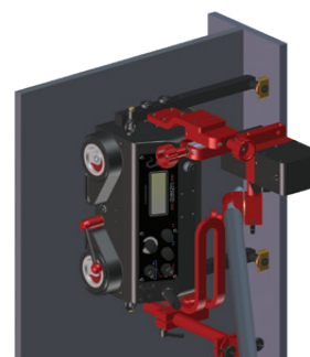
Kehlnaht-Schweißen mit Oszillator
