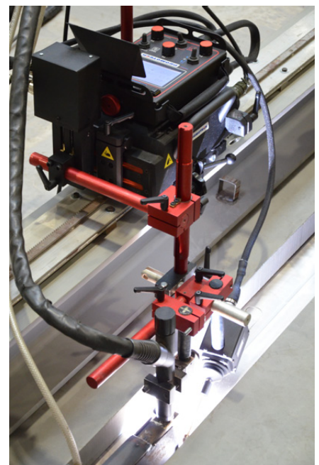
Nahtführung funktioniert mit und ohne Oszillation
