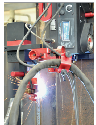
Kehlnaht-Schweißen mit Oszillator
