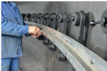
Einstell-Werkzeug der Zahnstange. Das Werkzeug beseitigt die Lücke zwischen den Zahnstangen Produkt-Code: PKT-0341-13-00-00-0
