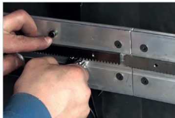
Einstell-Werkzeug der Zahnstange. Das Werkzeug beseitigt die Lücke zwischen den Zahnstangen Produkt-Code: PKT-0341-13-00-00-0
