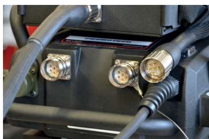
HF geschützte Signalbuchsen und Stecker
