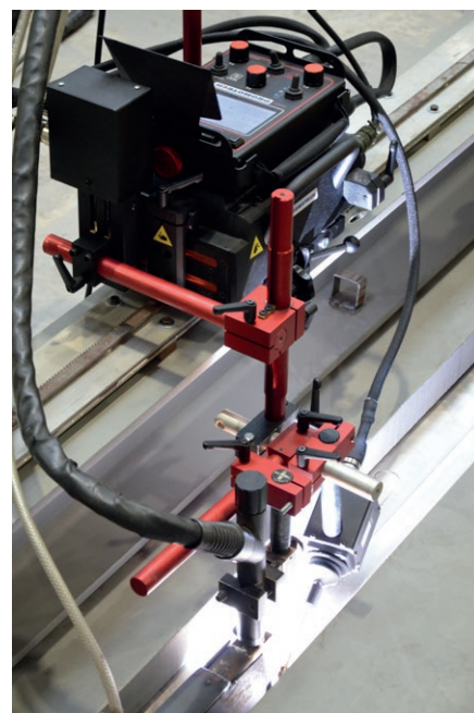
Nahtführung funktioniert mit und ohne Oszillation
