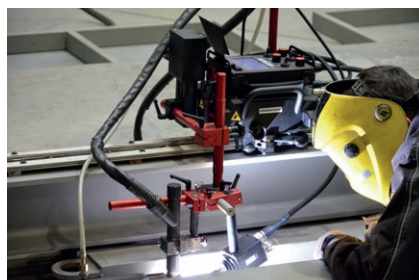
Soudage TIG d'une plaque de titane
