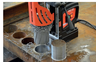
Capacità di foratura con frese a corona sino a 100 mm Massima profondità di taglio 100 mm Corsa 225 mm
