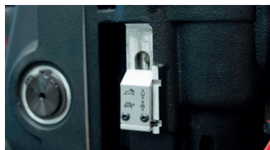
Riduzione giri a 2 marce per ottimizzare la velocità dell'utensile
