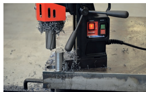
Foratura con frese a corona sino a 45 mm Profondità massima fino a 75 mm
