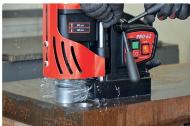
Capacità foratura con frese a corona sino a 65 mm
