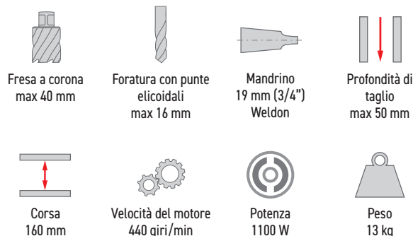
Foratura con frese a corona sino a 40 mm Profondità massima fino a 50 mm
