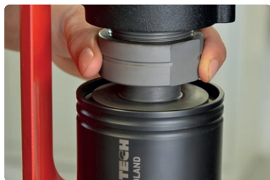
Mandrino per maschiatura con ghiera di fissaggio
