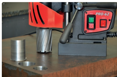
Profondità massima foratura sino a 75 mm
