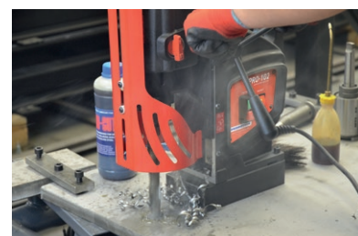
Foratura con punte elicoidali max 31.75 mm Design leggero di soli 24 kg
