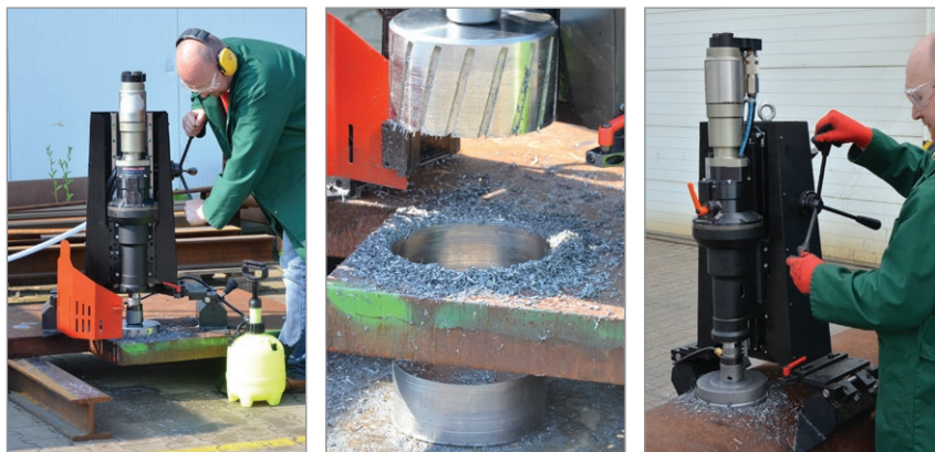
Capacità di fresatura max 200 mm
