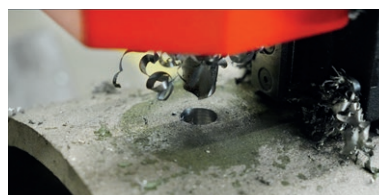
Foratura con punta elicoidale max 16 mm
