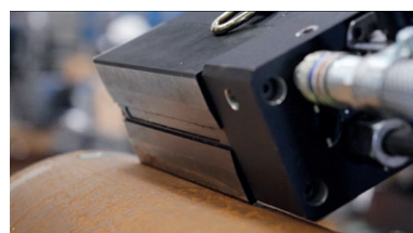
Base magnetica prismatica a V per la perforazione di tubi
