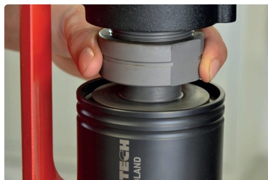
Mandrino per maschiatura con ghiera di sicurezza
