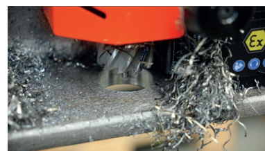
Foratura con frese a corona max 40 mm
