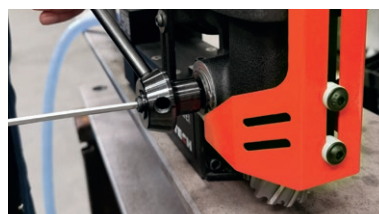
Possibilità di fissare la leva per l'avanzamento su entrambi i lati
