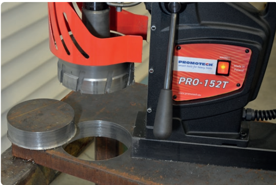
Foratura con frese a corona max 150 mm
