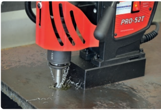
Maschiatura fori passanti sino a M20
