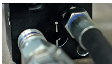
Indicatore del livello di serraggio per la sicurezza
