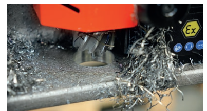
Maximale Fräskapazität 40 mm
