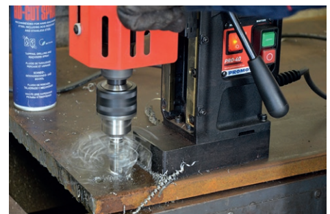
Bohrleistung bis zu 16 mm
