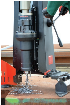
Bohrleistung bis 45 mm
