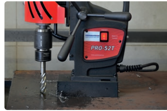
Gewindeschneiden von Sacklöchern bis M20
