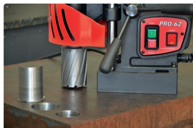
Maximale Schnitttiefe bis zu 75 mm
