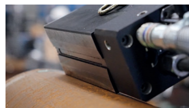
V-förmiger Magnetfuß zum Bohren von Rohren
