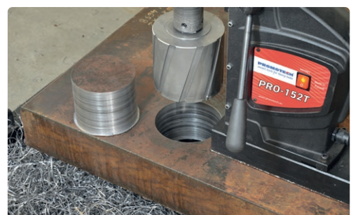
Maximale Schnitttiefe bis zu 100 mm
