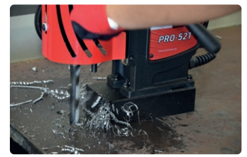
Bohrleistung bis zu 23 mm • Max. Hub bis zu 190 mm
