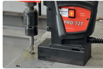
Gewindeschneiden von Sacklöchern bis M20
