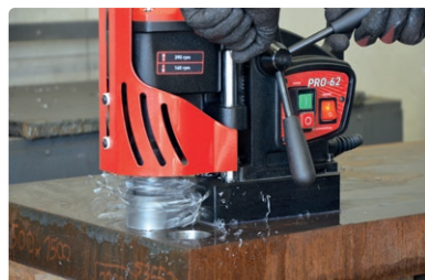
Fräseleistung bis zu 65 mm
