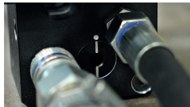
Anzeige des Spannniveaus für Sicherheit und Schutz
