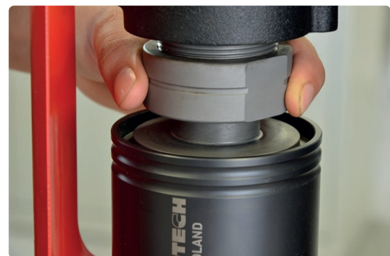
Gewindeschneidfutter mit Sicherungsmutter
