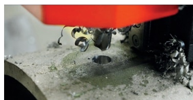
Maximale Bohrleistung 16 mm
