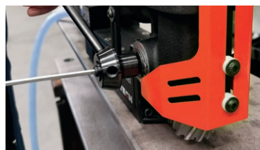
Der Vorschubhebel kann von beiden Seiten fixiert werden
