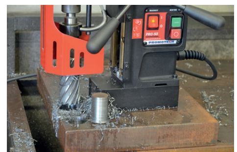
Maximale Fräskapazität bis zu 50 mm Maximale Schnitttiefe bis zu 75 mm - (Optional)
