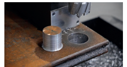
Maximale Schnitttiefe 50 mm
