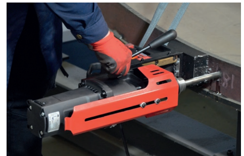
Bohrleistung bis zu 18 mm
