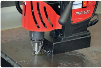
Durchgangsgewindebohren bis M20
