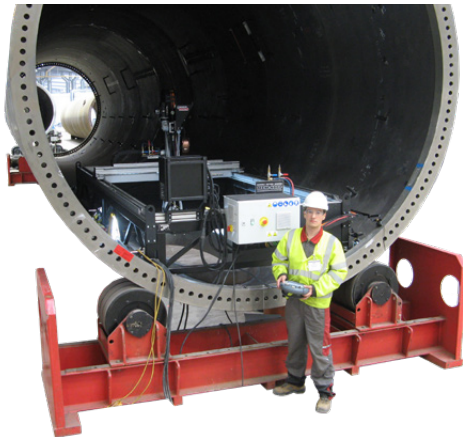
MOBILE 5-ACHSIGE CNC MASCHINE FÜR DAS DREIDIMENSIONALE BRENNSCHNEIDEN, ANFASEN UND SCHWEISSEN
