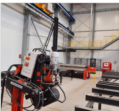
ABM-50 für hochwertige ein- und doppelseitige Nahtvorbereitung.
