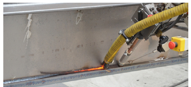
Die automatische Taktile-Nahtverfolgung von Promotech gewährleistet eine korrekte und wiederholbare Schweißung, welche sich durch eine einfache Schlacke-Entfernung beim UP-Prozess auszeichnet.
