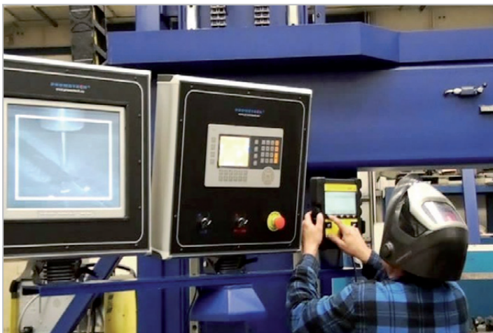
Beispielhafte Ansicht des CB-Bedienfeldes und der integrierten MIG-MAG-Schweißausrüstung von z.B. ESAB, LORCH, ...
