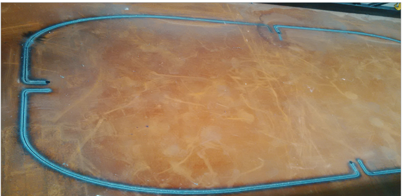
Das autogene Brennschneiden wurde durch das Promotech Team mit einer 3D MCM an einer Blechdicke von 80mm ausgeführt.
