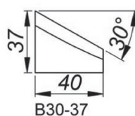
30° Schneidplatte für Anfassen Höhe 37 mm [B30/37] Produkt-Code: NOZ-000019
