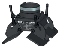
Aufsatz zum Entfernen von Schweißnahtüberhöhung am Rohr (min. AD 200 mm, min. ID 400 mm) mit Winkelerstellung von -10 bis +30 Grad PRW-0761-11-00-00-0
