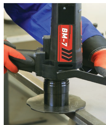
Gerade Kantenanfasen mit Radius
