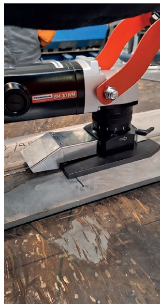
Aufsatz zum Entfernen von Schweißnähten an zylindrischen Längsflächen (min. ID 350 mm) mit einer Neigungswinkeleinstellung bis zu 15 Grad PRW-0761-12-00-00-0
