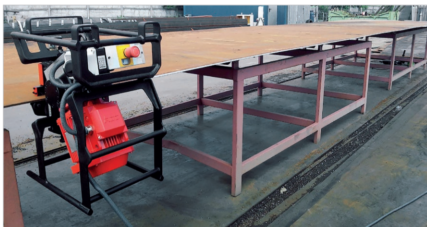
ABM-14 läuft automatisch an der Platte entlang
