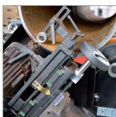
WSP-0436-24-00-00-0 Verfolgungsgerät für ovale Rohre Erhältlich entweder mit einer brandneuen Maschine oder zum Nachrüsten
