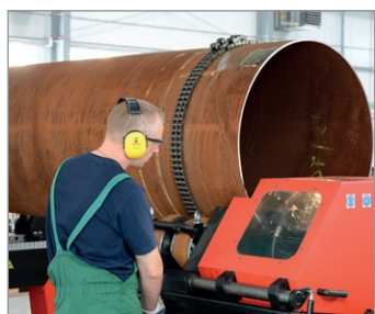
Schutzabdeckungen und interne Beleuchtung erhöhen Sicherheit und Komfort des Bedieners
