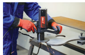
Gewölbte Kantenanfasen mit Radius
