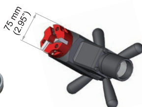
Mindestabstand zwischen den Rohren beträgt 75 mm
