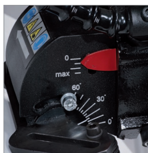
Kontinuierliche Winklereinstellung von 0 bis 60 Grad.
