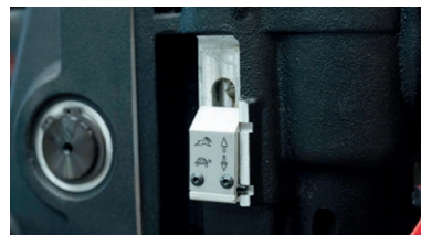
2-Gang-Getriebe zur Anpassung der Geschwindigkeit an das Werkzeug
