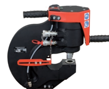
Ergonomische Lage der Bedienknöpfe auf der Rückseite
