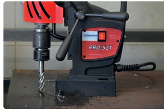
Gewindeschneiden von Sacklöchern bis M20
