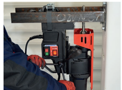
Bohren außerhalb der Position
