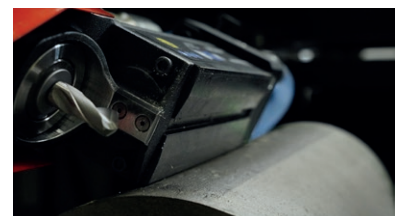
V-förmiger Magnetfuß zum Bohren von Rohren
