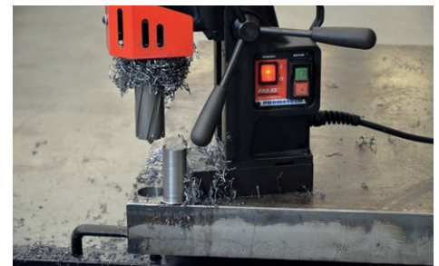
Maximale Fräskapazität bis zu 45 mm Maximale Schnitttiefe bis zu 75 mm
