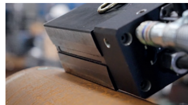
V-förmiger Magnetfuß zum Bohren von Rohren
