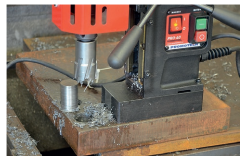
Maximale Fräskapazität bis zu 40 mm Maximale Schnitttiefe bis zu 50 mm
