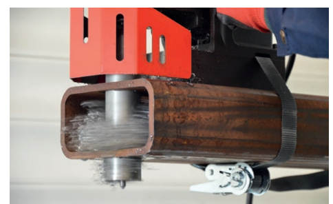
Startpunkt der Bohrung bis 50 mm unter dem Niveau des Bohrsockels mit 100 mm langem Fräser
