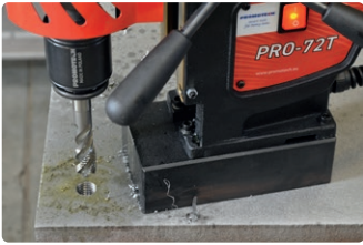
Gewindeschneiden von Durchgangsbohrungen bis M20
