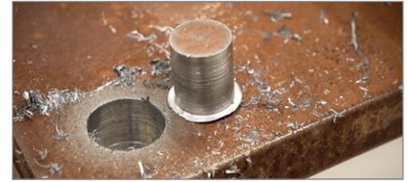
Capacità max di fresatura fino a 40 mm
