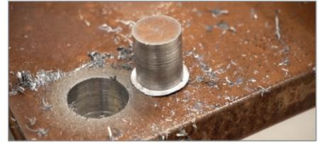
Máx. capacidad de fresado hasta 40 mm
