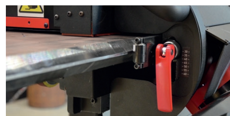
Reglare facilă în funcție de grosimea tablei
