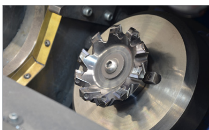
Acces ușor la capul de șanfrenare și la plăcuțele de șanfrenat
