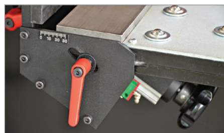
Setare ușoară a lățimii de șanfrenare
