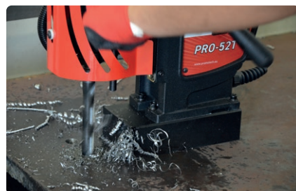
Spiraalboor max 23 mm (7/8") • Max slag tot 190 mm (7-1/2")
