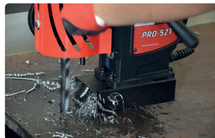
Capacidad de taladrado de hasta 23 mm • Máx. recorrido hasta 190 mm
