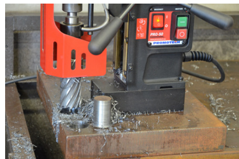
Maximale Fräskapazität bis zu 50 mm Maximale Schnitttiefe bis zu 75 mm - (Optional)
