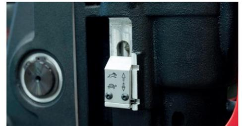
2-Gang-Getriebe zur Anpassung der Geschwindigkeit an das Werkzeug
