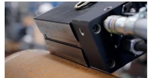
V-förmiger Magnetfuß zum Bohren von Rohren
