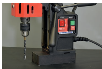
Adaptador 3/4" x 1/2" 20 UNF, Portabrocas 1/2" 20 UNF Broca helicoidal de hasta \Phi 11.8 mm (DIN 338)
