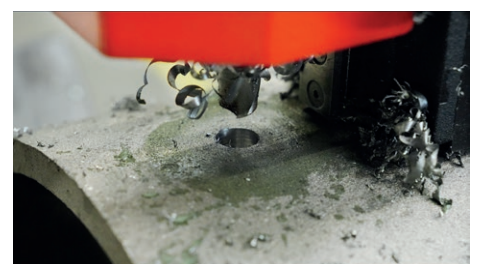
Maximale Bohrleistung 16 mm
