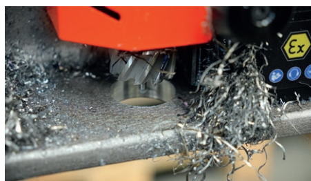
Maximale Fräskapazität 40 mm
