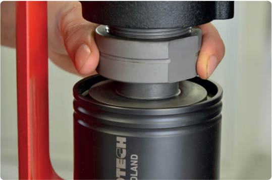
De tapkop met borgmoer beschermt het tapgereedschap tegen uittrekken
