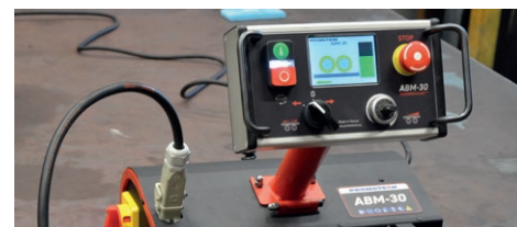
Het bedieningspaneel geeft de huidige werkmodus aan en geeft veiligheids- en diagnostische informatie
