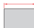
Larghezza minima del particolare 50 mm (30 mm optional) Lunghezza minima del particolare 150 mm
