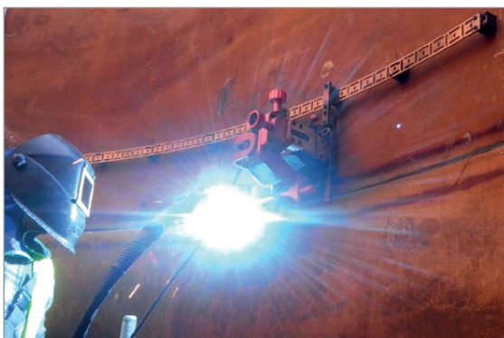
Lange flexible Schiene 185 cm 1 St. Minimaler Krümmungsradius von 1,0 m PRW-0466-50-01-01-0
