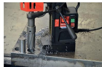
Capacidad de fresado de hasta 55 mm
