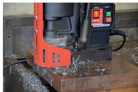
Capacidad de fresado de hasta 55 mm
