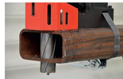
Punto de inicio de fresado hasta 50 mm por debajo del nivel de la base de perforación
