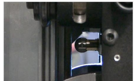
Kontaktblöcke schützen Rail Titan vor dem Herunterfallen aus einem Gleis mit offenen Enden. Wenn der Traktor den Kontaktblock erreicht, wird der Endschalter aktiviert.
